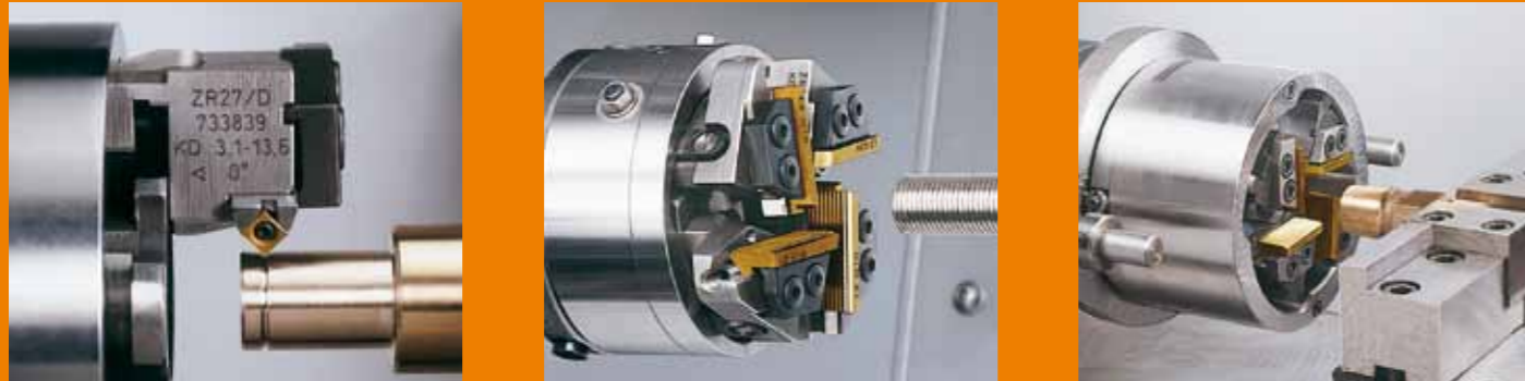
Levá strana: ZR 27 s HM-zapichovací destičkou | ZA 22 na CNC-řízeném soustruhu | Kuželový závit obráběný pomocí Z 27 GK Pravá strana: Z 39 na závitořezném stroji | Velká hlava GEWE-S na vřetenu závitořezného stroje
