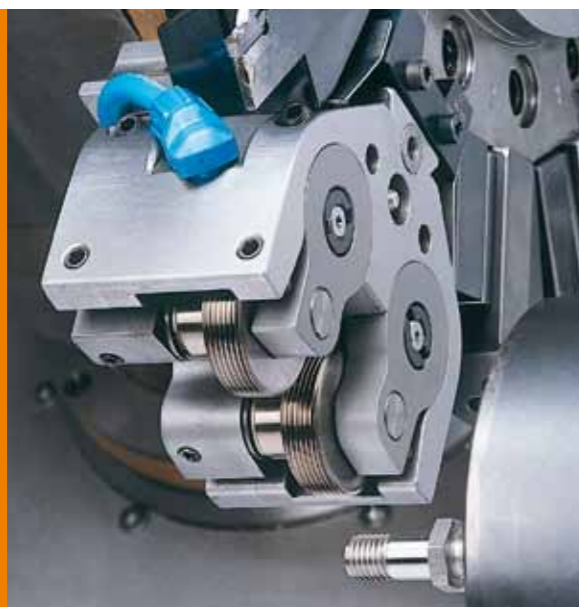
WAGNER®-Stranový válcovací nástroj před osazením
