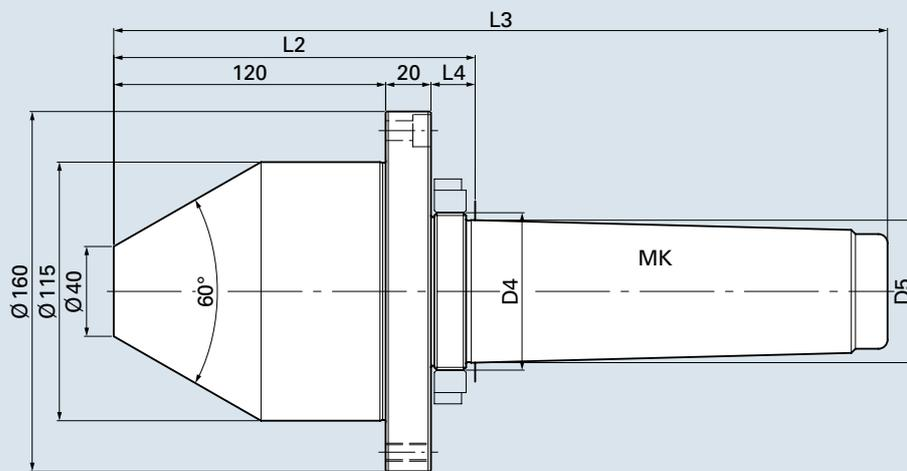
Werkstücke mit Zentrierungen von Ø40 bis Ø115 können mit der Grundaufnahme gespannt werden. Grundaufnahme inkl. Abdrückmutter.
