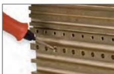
Dieses Miniwerkzeug erzeugt eine hochwertige Oberflächenbehandlung bei Präzisionsteilen. Besitzt eine extra schmale dreieckige Klinge mit 3 Schneidkanten für qualitativ hochwertige Oberflächenbehandlung und Schaben.
