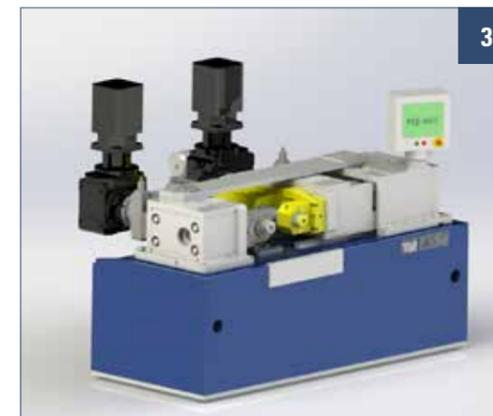
Dabei sind die mit 2 CNC gesteuerten hydraulischen Rollspindelachsen ausgestatteten Maschinen bestens für eine zentrische Bearbeitung der Werkstücke ausgelegt. Die dementsprechend mittig positionierte Vorrichtung, bei offener Zugänglichkeit, gewährleistet immer ideale Automationsvoraussetzungen.
